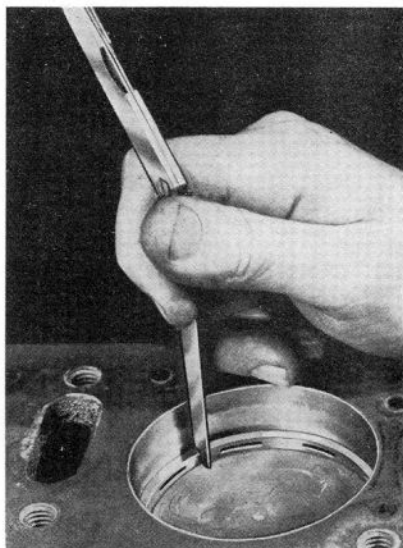
FIGURE 25.—Vérification de la fente des segments.
