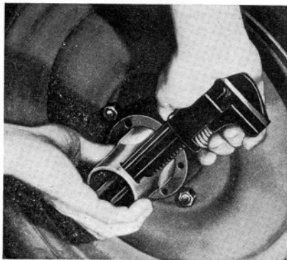
FIGURE 4.—Mise en place de l'écrou de moyeu
