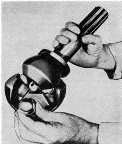
FIGURE 8.—Assemblage des billes du joint de cardan, type Bendix.
