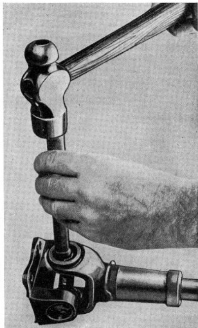
FIGURE 3.—Démontage des roulements à aiguilles des joints de cardan des arbres de transmission.
