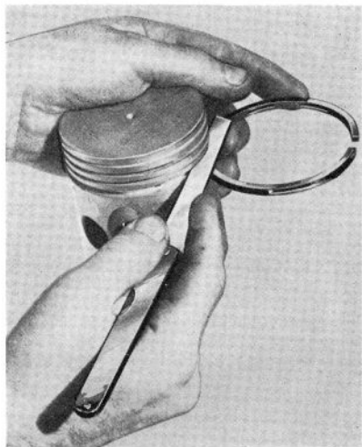
FIGURE 27.—Ajustage du segment racleur.
