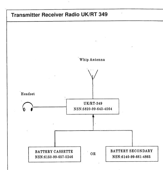
SCHEMATIC DIAGRAM OF RADIO STATION UK/PRC 349
